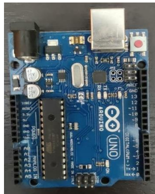
Fig 4. Arduino UNO Board (controller)
